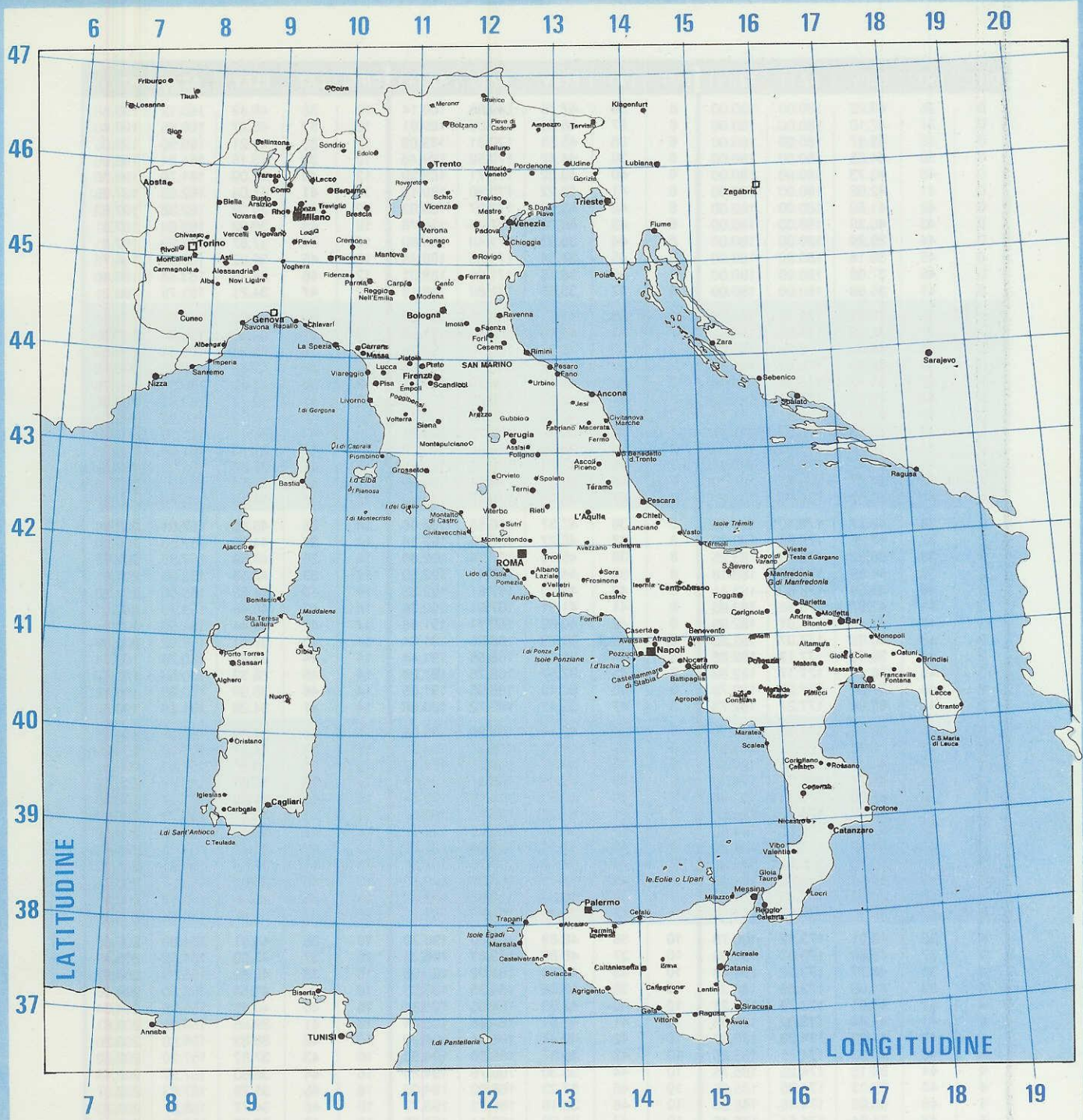
Fig. 1 In questa cartina sono riportate la Longitudine e la Latitudine di tutte le località italiane, necessarie per ricavare i dati di Elevazione e di Azimut del luogo in cui ci troviamo ad operare. Come spiegato nell'articolo, se il satellite si trova ad Est di Greenwich, dovremo eseguire una "sottrazione", mentre se si trova ad Ovest, una "addizione". Nella prima colonna della tabella riportata nelle pagine seguenti, dovremo cercare il numero ricavato da tale operazione e, nella seconda colonna, la nostra "Latitudine". Passando alla terza colonna, individueremo i gradi di "Elevazione" e, nelle successive due colonne, i gradi negativi e positivi di "Azimut".
